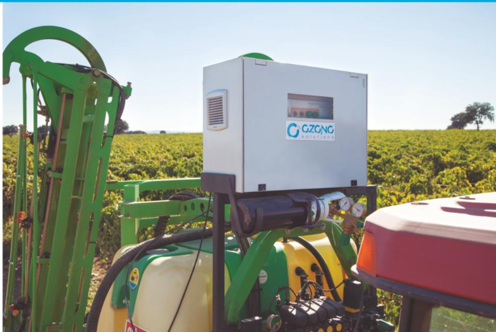
Sistema de ozono profesional para tratamiento del agua en el depósito del atomizador, nebulizador, etc., de forma inmediata. Sin tiempo de espera para disponer de agua ozonizada.
